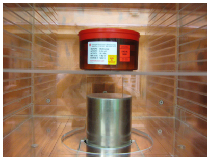
写真 2.8.8-1 標準体積線源の設置状態 (従来法実測位置)
