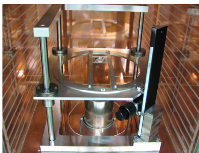
写真 2.8.8-2 標準点線源の設置状態と専用治具
